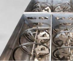
En el sistema no existen válvulas ni compuertas, mantiene su nivel en todos sus compartimentos, pudiéndose conseguir el total vaciado al disponer de unas compuertas para tal efecto.
